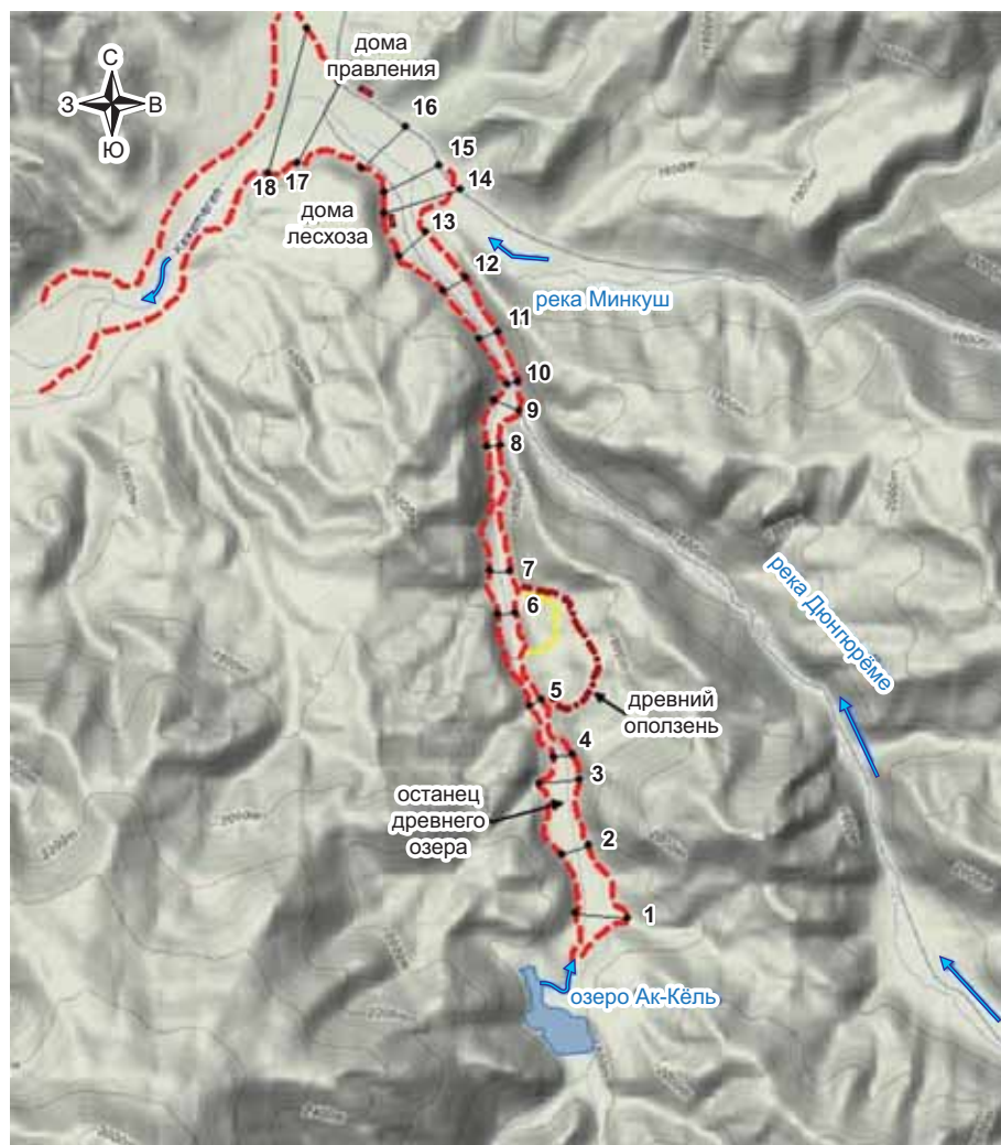
Рис. 5. Карта зоны затопления селевым потоком (красная пунктирная линия) при гипотетическом прорыве озера Ак-Кёль с указанием расчетных створов и древнеоползневых участков
