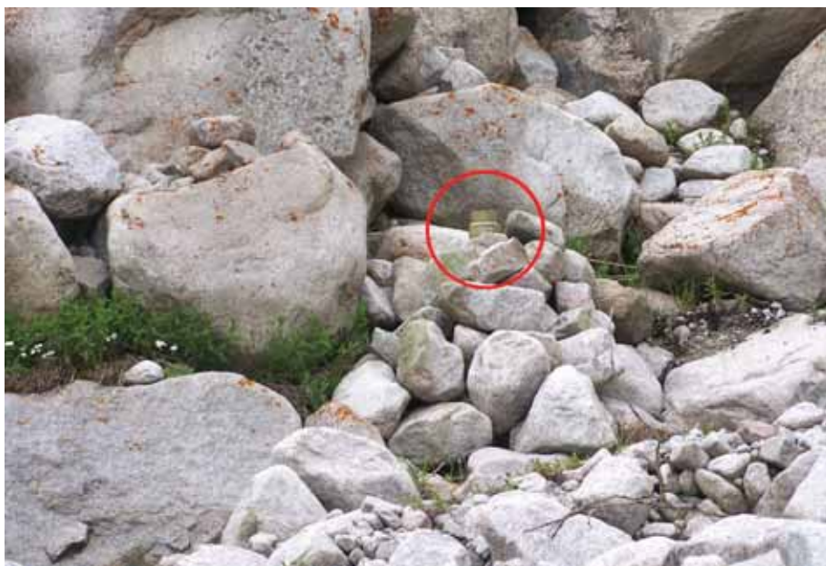
Рис. 4. Радиосенсор в каменном русле реки Аксай (место его установки обведено красной окружностью)
