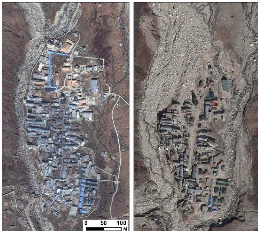
Рис. 6. Посёлок Кедарнатх до и после прорывного паводка на фрагментах мозаик космических снимков Bing Maps 2011 г. и Google Earth 2013 г.
