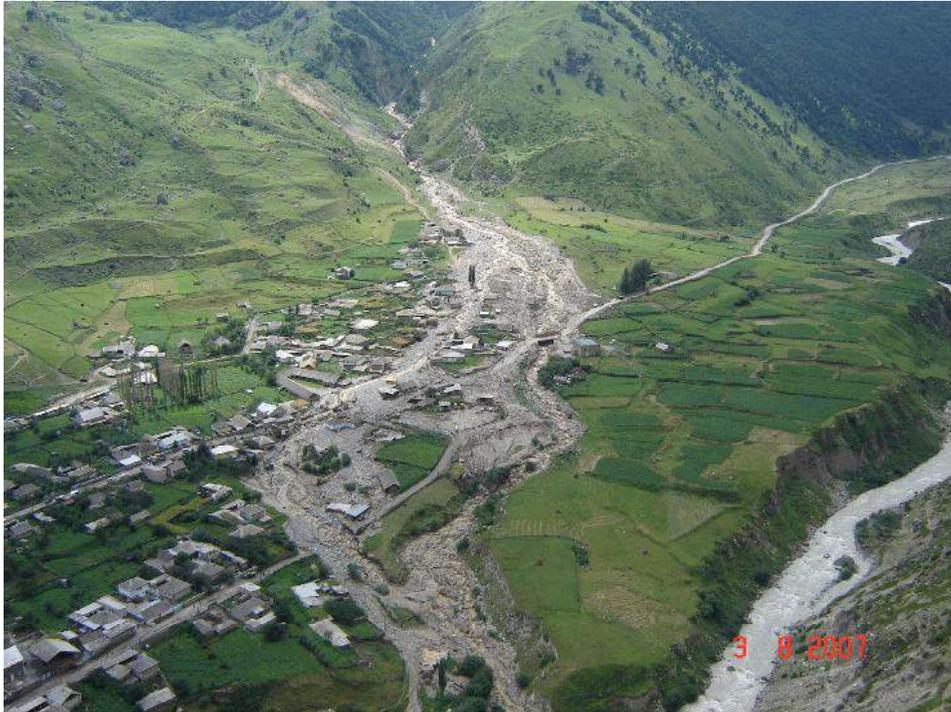
*Рис. 9. 03 августа 2007 г. Пос. Булунгу (КБР) под селевыми отложениями р. Булунгу-Суу. Снимок с вертолёта*
