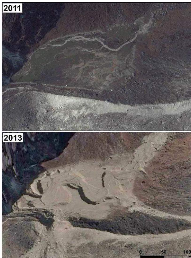
Рис. 5. Котловина озера Чорабари: а – фото из [3], б – фрагменты мозаик космических снимков Bing Maps 2011 г. и Google Earth 2013 г. до и после прорыва озера
