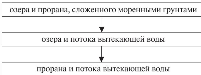
Предлагаемая схема позволяет проследить процесс катастрофического опорожнения как совокупность элементарных процессов, которые могут
