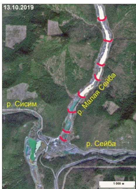
Рис. 9. Р. Малая Сейба. Красноярский Край, Россия. Прорыв каскада дамб золоторудного месторождения 19 октября 2019 г: а – 25 октября 2019 г. размывается верхняя дамба каскада искусственных запруд https://imag.one/news/rosprirrodnadzor-razrabotku-mestorozhdeniya-z/1351115 , б – космоснимки Sentinel 2A до и после прорыва запруд. Красный контур – зона поражения селевым потоком
