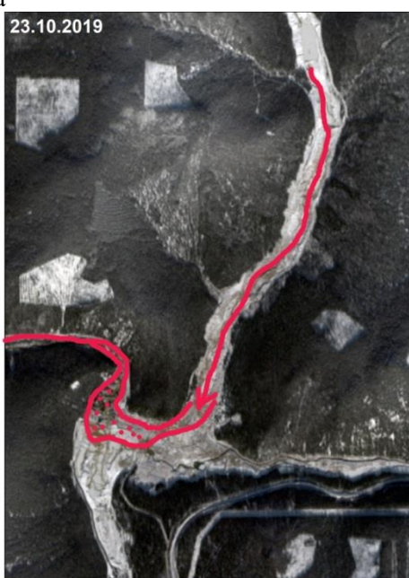
Рис. 9. Р. Малая Сейба. Красноярский Край, Россия. Прорыв каскада дамб золоторудного месторождения 19 октября 2019 г: а – 25 октября 2019 г. размывается верхняя дамба каскада искусственных запруд https://imag.one/news/rosprirrodnadzor-razrabotku-mestorozhdeniya-z/1351115 , б – космоснимки Sentinel 2A до и после прорыва запруд. Красный контур – зона поражения селевым потоком
