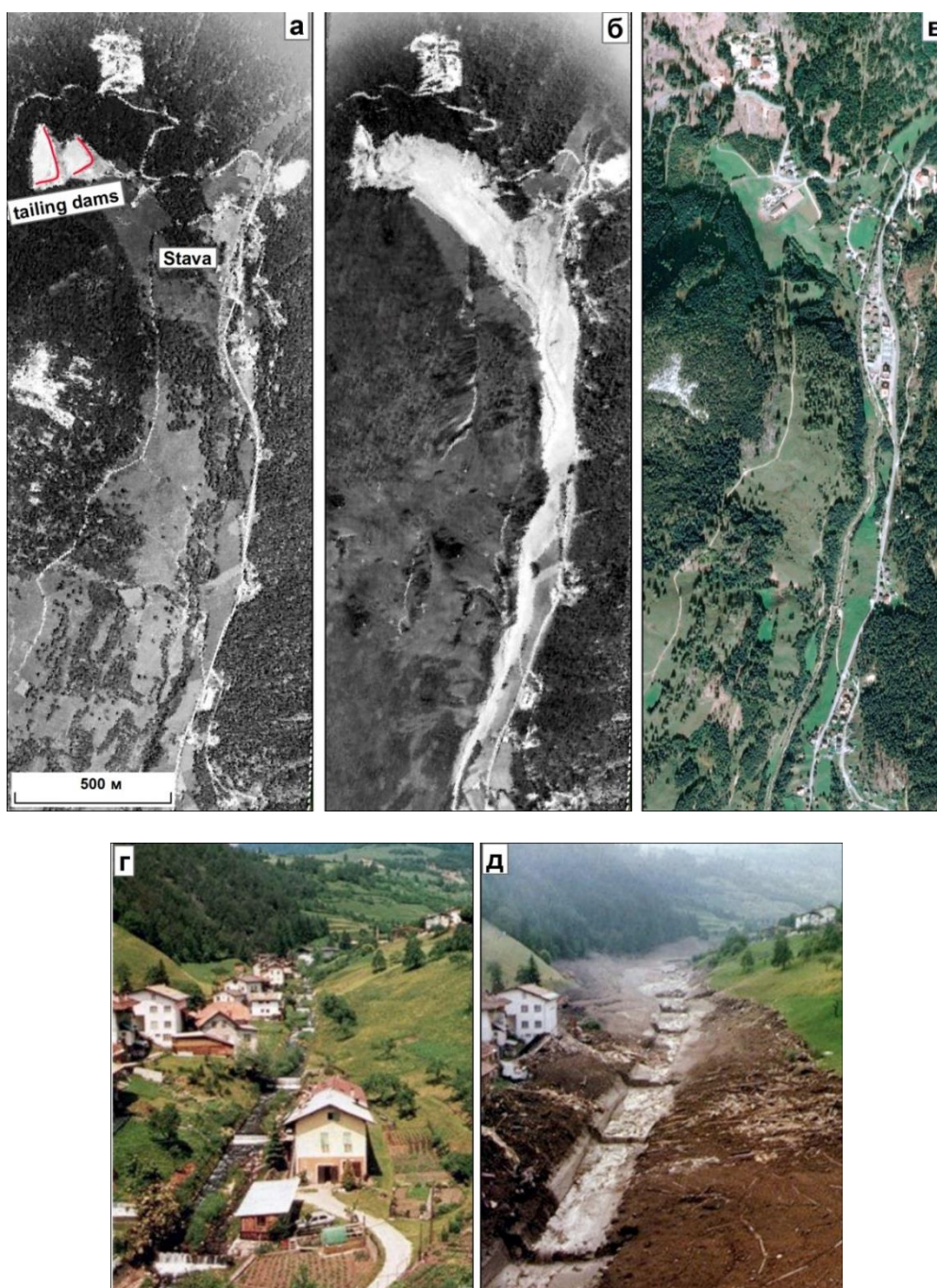
Рис. 11. Италия. г. Става. 19 июля 1985 г. Фрагменты аэрофотоснимков до и после обрушения дамб хвостохранилищ (а, б), фрагмент космического снимка WorldView2 от 07.10.2017 (в); фото г. Тесеро и долины р. Авицио до и после катастрофы, фото П. Треттель, обработка М.Д. Докукина (г, д)
