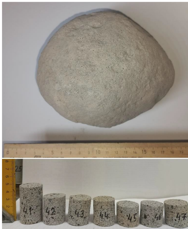
Рис. 5. Крупнообломочное валунно-галечное включение и выбуренные из него цилиндрические образцы
