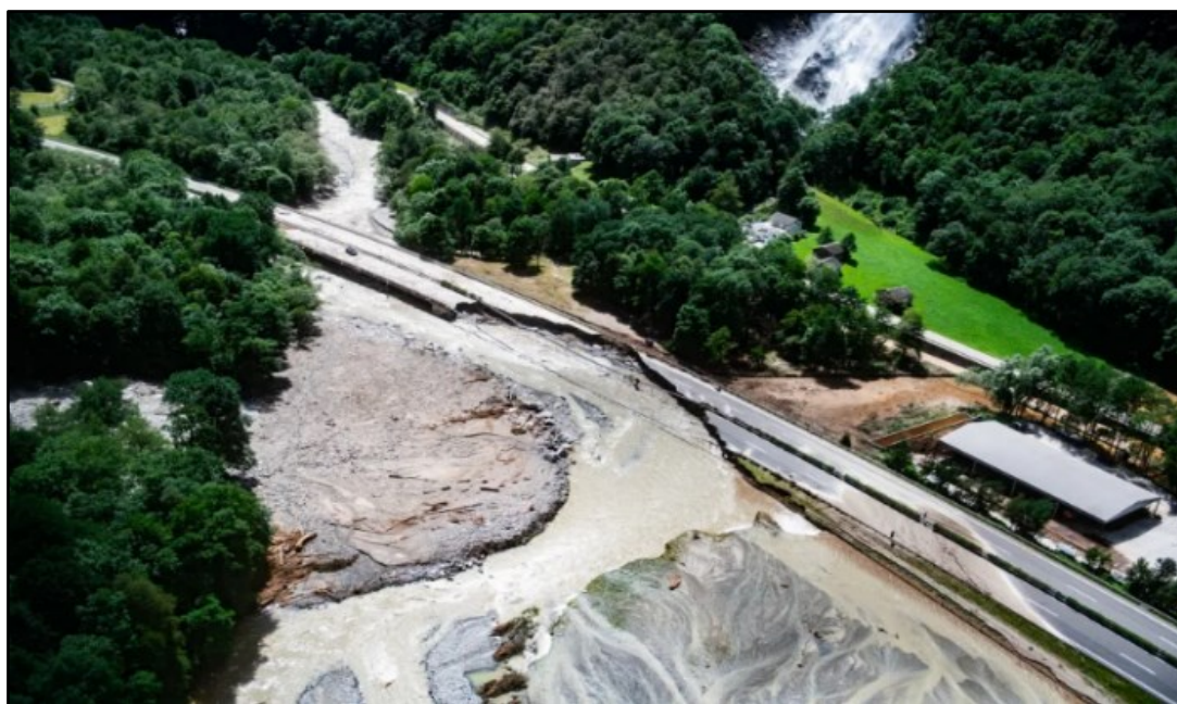
Рис. 11. Один из участков вогнутого берега, размываемого водным потоком. Фото из сети «Интернет»
