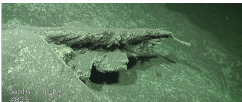
Рис. 5. Обрыв кабеля в зоне транзита обломочного потока большой плотности
