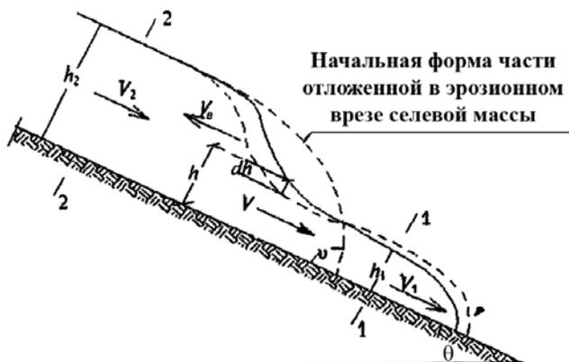
**Рис. 5.4. Схема процесса возникновения обратной отрицательной волны в результате срыва гиперконцентрированной селевой массы с эрозионного среза**
